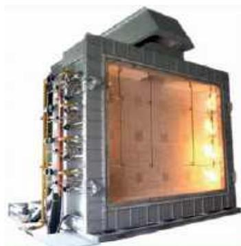
Foto 3 – Horno de pruebas de resistencia al fuego para elementos constructivos.
