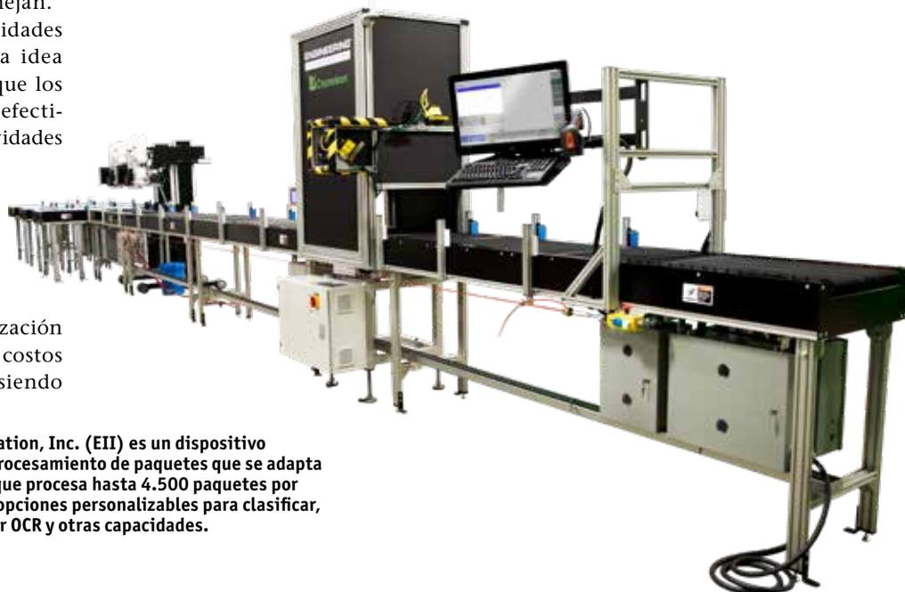
**El Chameleon® de Engineering Innovation, Inc. (EII) es un dispositivo altamente configurable sistema de procesamiento de paquetes que se adapta al entorno de cada cliente a medida que procesa hasta 4.500 paquetes por hora. Con su diseño modular, ofrece opciones personalizables para clasificar, etiquetar, leer códigos de barras, leer OCR y otras capacidades.**
