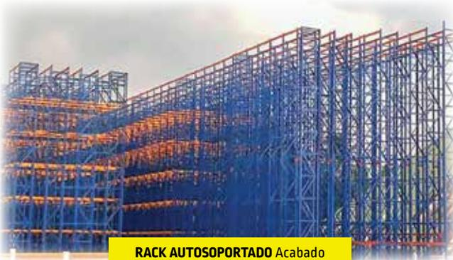
**RACK AUTOSOPORTADO** Acabado en pintura epóxica poliéster horneada
