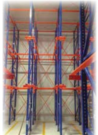
**RACK DRIVE IN** Acabado en pintura epóxica poliéster horneada
