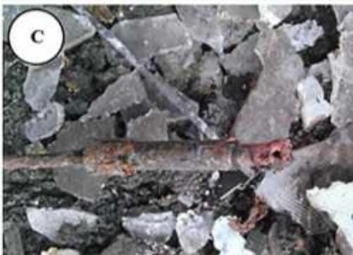
(C) Restos de un conector de CC destruido por arcos y aislamientos quemados.
