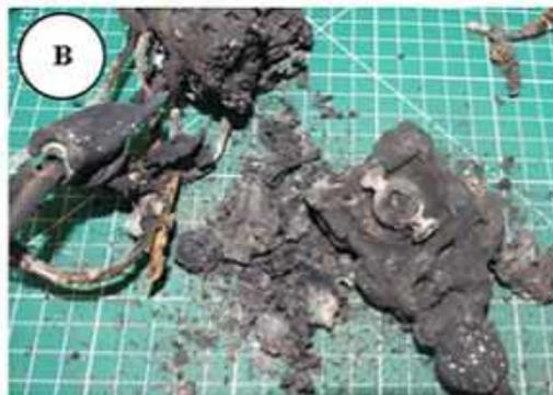
(B) Restos de un aislador de CC desmontado e inspeccionado en el laboratorio.
